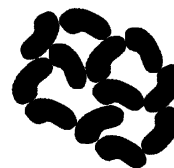
Рис. 11.3. Конденсационно-кристаллизационная структура (хрупкий гель)
