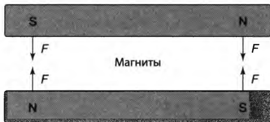
Рис. 18.1. Силы, созданные постоянными магнитами
