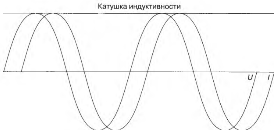
Рис. 19.11. В катушке индуктивности напряжение опережает силу тока
