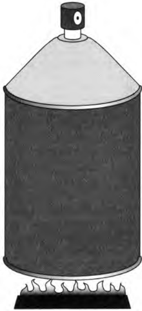
Рис. 15.3. В изохорическом процессе объем остается постоянным, а другие параметры меняются
