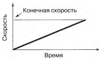
Рис. 3.5. Характер увеличения скорости при постоянном ускорении
