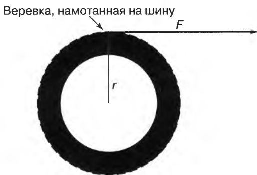
Рис. 11.3. Схема приложения силы к шине колеса
