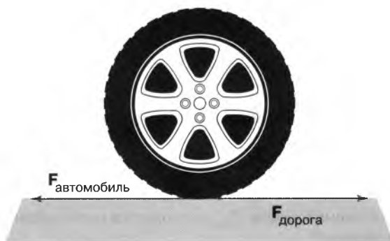
Рис. 5.5. Сила F_{\text{автомобиль}} , прилагаемая к дороге со стороны шины автомобиля, и сила противодействия дороги F_{\text{дорога}}
