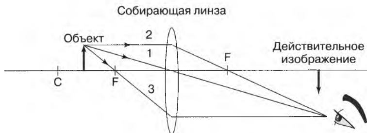
Рис. 20.11. Собирающая линза с объектом, расположенным в пределах радиуса кривизны, но дальше фокусного расстояния
