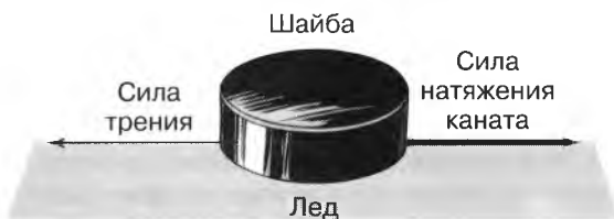
Рис. 5.6. Распределение сил натяжения каната и трения при перемещении шайбы по льду с помощью каната
